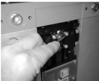
5. Volver a insertar la tobera de aire de regeneración en el bloque de válvulas una vez que se haya secado completamente. Asegúrese de que las juntas tóricas se encuentran en buen estado y de que se han colocado correctamente.
