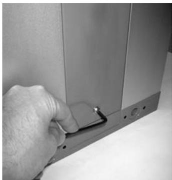
2. Retirar tornillo de fijación (1 tornillo).
