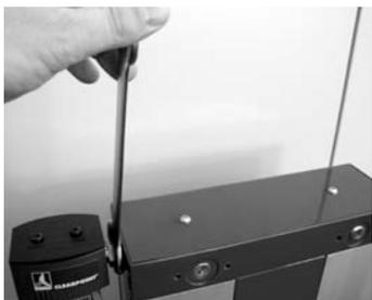
1. El filtro de entrada se encuentra instalado verticalmente con respecto al secador. Desmóntelo.
