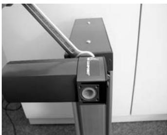
3. El filtro de entrada está instalado en posición horizontal con respecto al secador (formando un ángulo recto con el secador). Vuelva a apretarlo.
