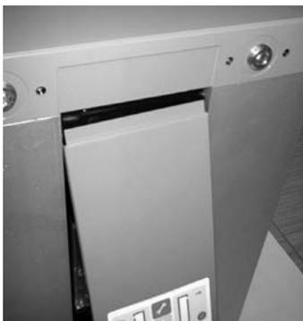
5. Volver a colocar el panel introduciendo el resorte en la ranura y empujando hacia arriba y hacia dentro.
