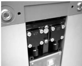
1. Retirar la cubierta frontal tal y como se describe en 11.5. La tobera de aire de regeneración se encuentra en el bloque de válvulas superior.
