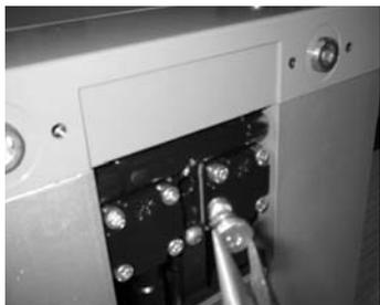
3. Extraer la tobera de aire de regeneración del orificio del bloque de válvulas superior.
