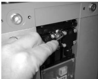
2. Retire el tornillo de fijación de la tobera de aire de regeneración.
