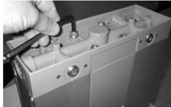
6. Girar el distribuidor múltiple 180° y volver a fijarlo con ayuda de los cuatro tornillos. Procure que las dos juntas tóricas del bloque de válvulas queden colocadas correctamente.
