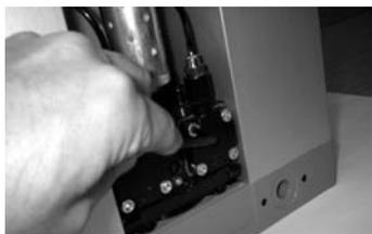
3. Soltar los cuatro tornillos de fijación para retirar las tapas.
