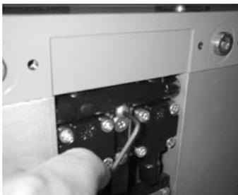
6. Volver a colocar y apretar el tornillo de fijación de la tobera de aire de regeneración en el bloque de válvulas superior.
