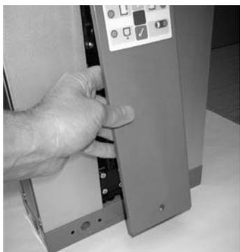
3. Para retirar el panel, inclínelo ligeramente hacia afuera y tire hacia abajo.
