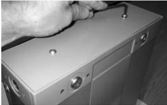
2. Soltar los dos tornillos de fijación de la tapa y retirarla.
