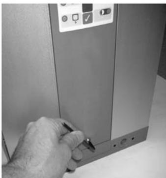
6. Vuelva a apretar el tornillo de fijación (1 tornillo).
