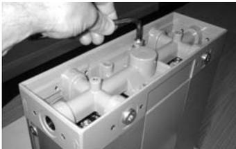
4. Soltar los cuatro tornillos de fijación del distribuidor múltiple y retirarlo.
