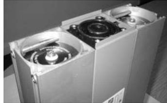
5. Secador después de desmontar el distribuidor múltiple.
