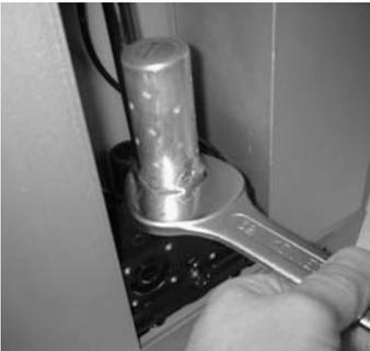
2. Desenroscar el silenciador del bloque de válvulas.
