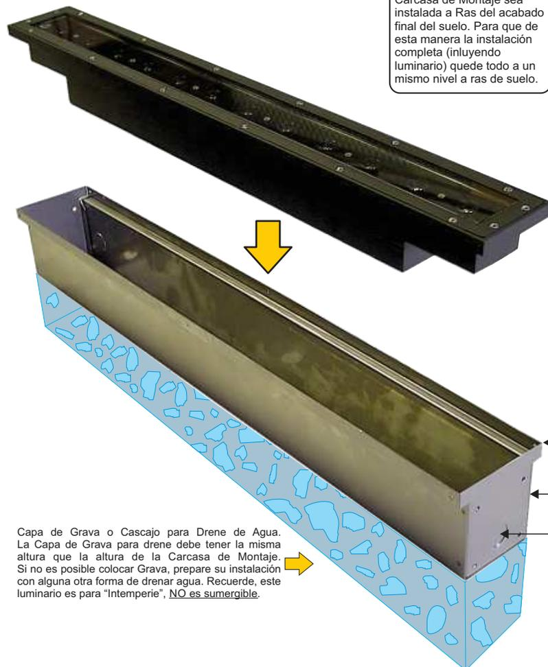
Capa de Grava o Cascajo para Drene de Agua. La Capa de Grava para drene debe tener la misma altura que la altura de la Carcasa de Montaje. Si no es posible colocar Grava, prepare su instalación con alguna otra forma de drenar agua. Recuerde, este luminario es para "Intemperie", **NO es sumergible**.
