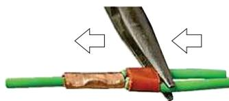
Deslice el Empaque Rojo, hacia arriba; De modo que esté casi en Contacto con el Conector de Cobre. Puede ayudarse de unas pinzas.
