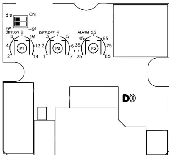
Para hacer un forzado MANUAL del relé , desconectar la sonda S1 (Sonda Colector). Se conecta el relé y se enciende el led y el led parpadea de forma rápida.
