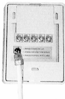
Cuando instale más de un monitor, éstos deben ser cableados en paralelo. Sólo un monitor debe ser conectado a la cámara utilizando el cable telefónico incluido o cableando los terminales de la cámara.
