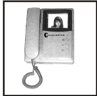
2. Levante el auricular y hable con el visitante, la imagen se apagará luego de un período de 40 a 100 segundos. Para volver a ver la imagen, presione el botón del monitor (3).
