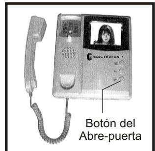
**Nota :** Para poder utilizar esta función, debe tener instalado en su puerta un cerrojo eléctrico de acuerdo a las especificaciones indicadas.
