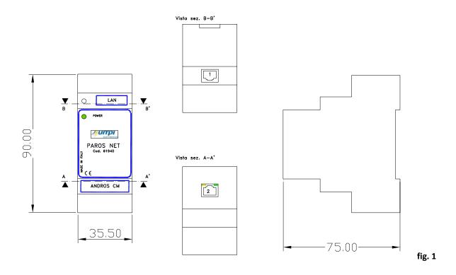
**PAROS NET** está dotado de dos tomas para conectores RJ 45 para el conexionado con ANDROS CM y con la red LAN. **Está** realizado en contenedor para barra **DIN de 2 módulos**.
