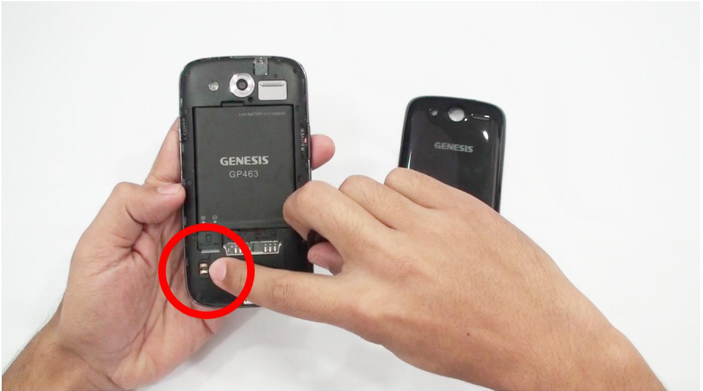
**b)** Despegamos el adhesivo de la placa y adherimos la misma al Smartphone de manera que el conector encaje perfectamente.
