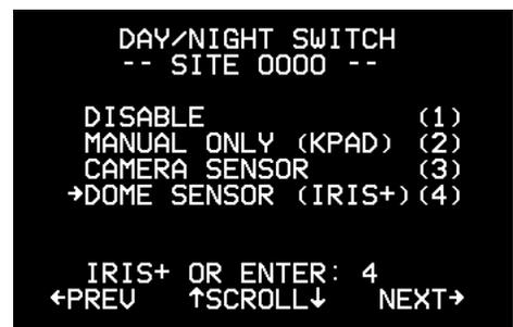
Si selecciona el sensor del brazo de inclinación de la unidad PTZ, tendrá que indicar a qué nivel desea que se produzca el cambio (Figura 20) El momento de cambio según el nivel de luz se puede ajustar, pero deben establecerse únicamente en condiciones de luz de amanecer o anochecer.
