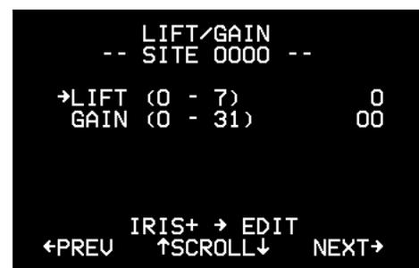
La ganancia optimiza el brillo del vídeo cuando se utilizan cables coaxiales de longitud considerable (*Figura 27*). La ganancia incrementa la amplitud de la señal de vídeo para aumentar a su vez el brillo del vídeo oscurecido y para reducir el ruido del vídeo de baja calidad. Utilice el joystick para ajustar la ganancia. El movimiento hacia arriba aumenta la ganancia y el movimiento hacia abajo la reduce.
