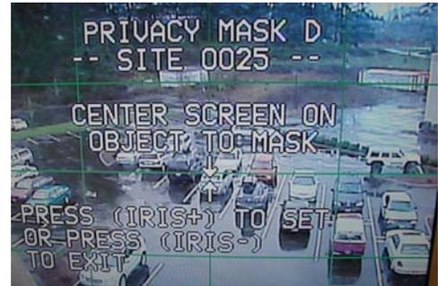
6. Establezca el tamaño de la máscara utilizando el joystick hacia arriba o hacia abajo para aumentar o reducir su tamaño verticalmente (*Figura 66*), o hacia la derecha e izquierda para aumentar o disminuir el tamaño en sentido horizontal.
