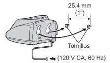
Coloque el cargador (1), y después deslícelo hacia abajo (2) y a la derecha
