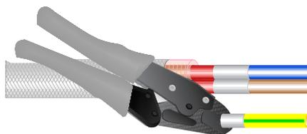
8. Uniremos cada uno de los extremos del cable calefactor al cable de red, utilizando los terminales metálicos (CuSn). Haremos lo mismo con el extremo de la malla y con el cable toma tierra.
