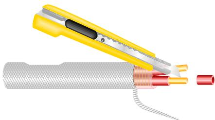
7. Desforraremos los extremos de ambos conductores.
