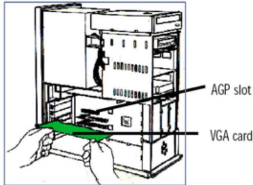
3. Retire, si estuviera, la tarjeta gráfica antigua. Para ello, primero afloje el tornillo que fija la tarjeta a la carcasa. Coja la tarjeta por los bordes y tire de ella con cuidado para extraerla de su ranura. Finalmente, introduzca con cuidado su tarjeta, la TerraTec Mystify 420, en una ranura AGP libre y ejerza una leve presión hasta que se fije.
