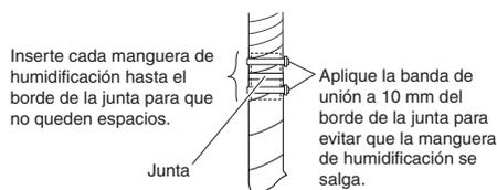
Inserte cada manguera de humidificación hasta el borde de la junta para que no queden espacios.
