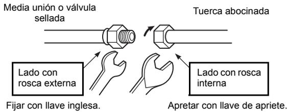
2. Como se muestra en la ilustración, utilice las dos llaves para aflojar o ajustar la tuerca abocinada de la válvula del lateral del gas. Si utiliza una sola llave, no podrá ajustar la tuerca abocinada con el par de apriete necesario.
