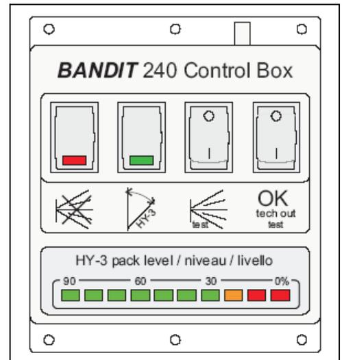
Este interruptor le permite manejar la central que controla la alarma en una simulación, en donde **BANDIT** se activa, pero no se produce el disparo de niebla.
