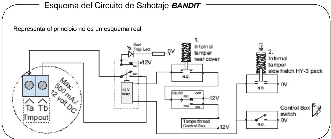
El cable de conexión de salida [Tmput] debe estar integrado al circuito de sabotaje de la instalación de alarma direccionada.
