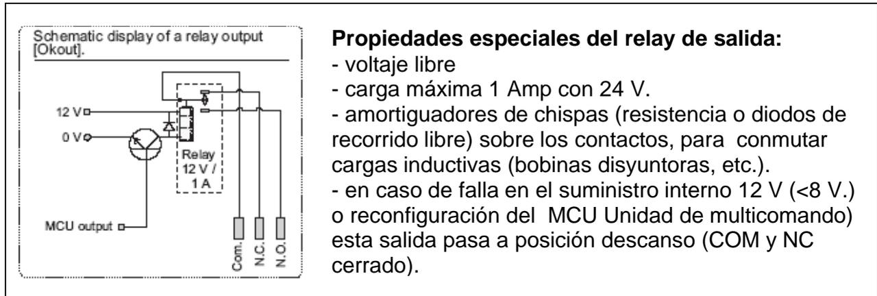
El relay de contacto está representado por 3 conectadores de impresión [Okout] sobre el PCI.
