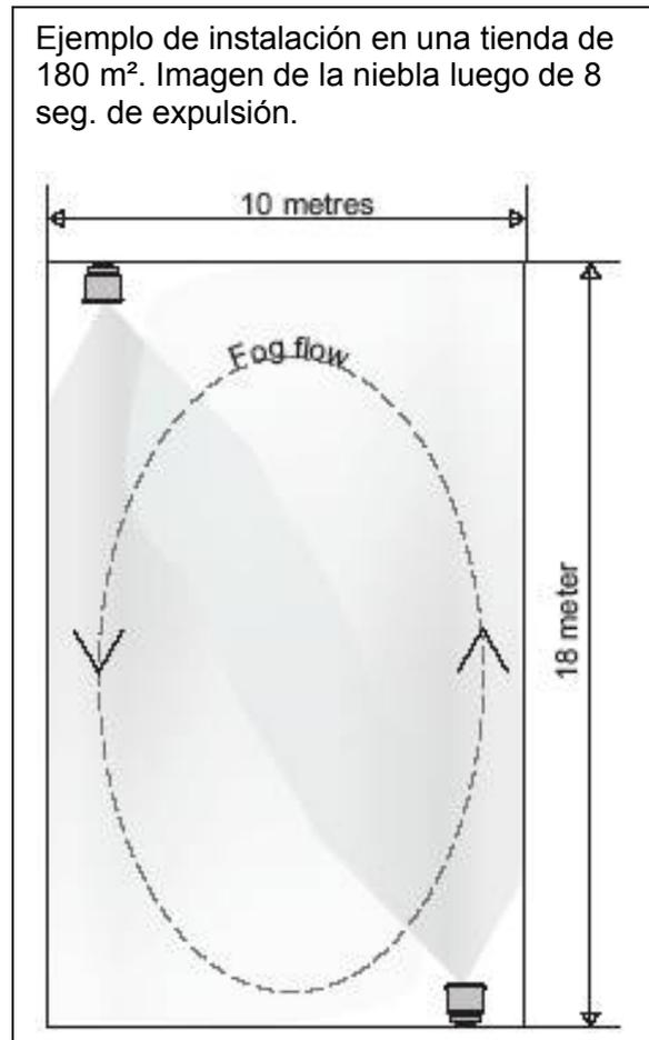
**BANDIT 240** tiene una capacidad de llenado de una habitación de ~28 m<sup>3</sup> por segundo. Esto corresponde a ~10 m<sup>2</sup>/sec. La superficie máx. que se puede asegurar con un dispositivo es igual al período máx. de expulsión de niebla de = 18 s x 10m<sup>2</sup>/s que es 180 m<sup>2</sup>.
