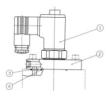
• Cambie la válvula de pilotaje asegurándose de que las juntas tóricas están correctamente colocadas. Después de confirmar la instalación de las juntas tóricas, apriete con fuerza los tornillos a un par de apriete comprendido entre 7 v 9 Nm.
