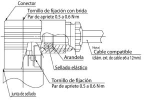
Nota) Para diámetro exterior de cable de ø9 a 12 mm, retire las piezas internas del sellado elástico antes de su uso.
