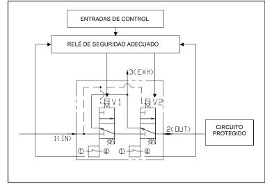
El diagrama muestra la válvula (en el recuadro de línea discontinua) conectada a un relé de seguridad en modo redundante conforme a los principios del Estándar de seguridad.
