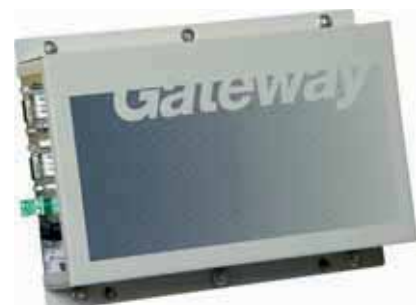
Centralita de conexión a BMS
