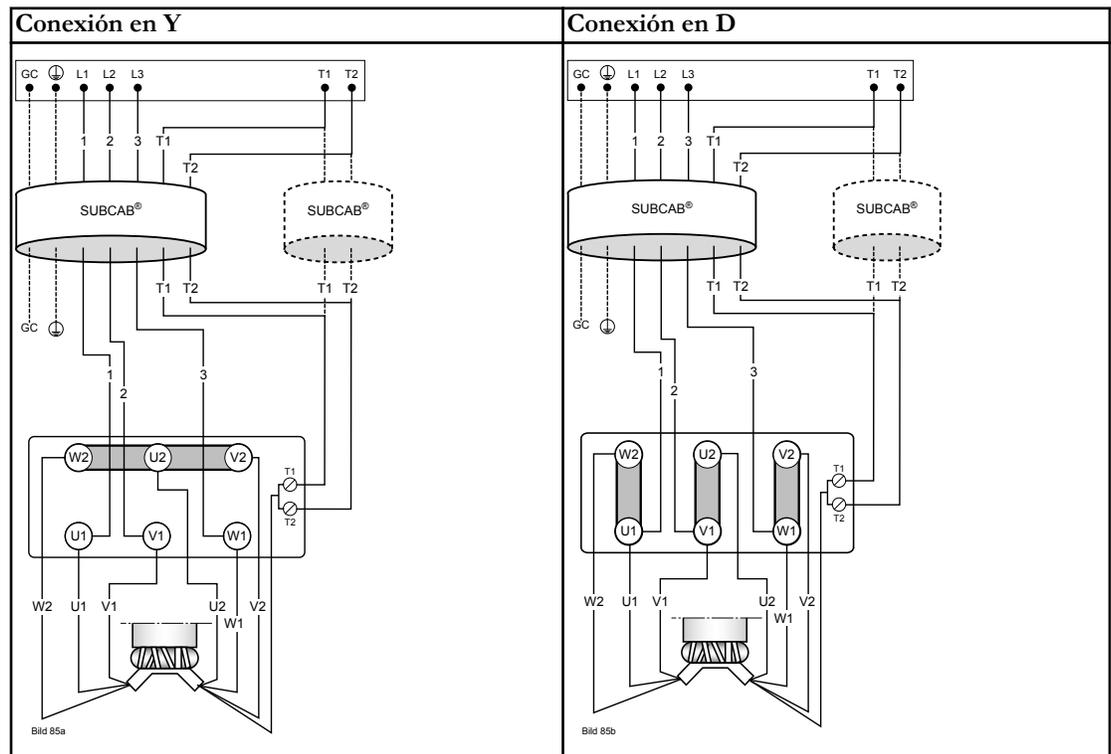
**SUBCAB 4GX/SUBCAB AWG, 9 conductores, 230/460 V, conexión en Y**
