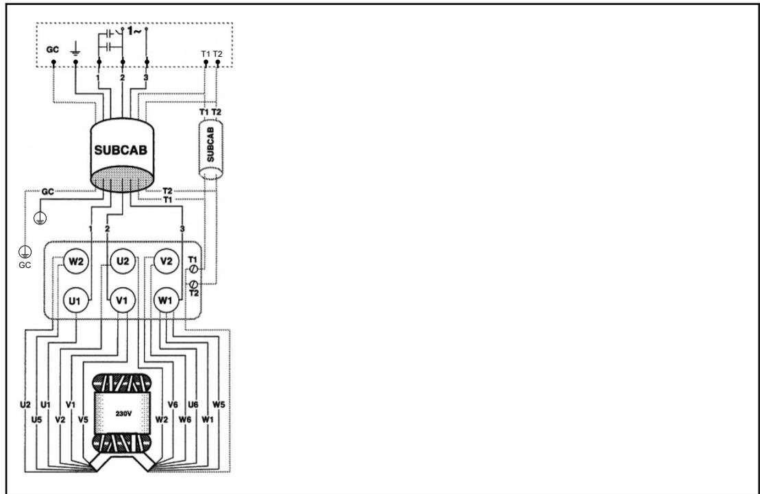
**SUBCAB 4GX/SUBCAB AWG, estátor de 6 conductores, conexión en Y y D**
