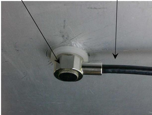
A continuación en la foto puede observarse el conector tipo BNC hembra del cable de antena RG 58 colocado en posición de trabajo al Receptor LISO.
