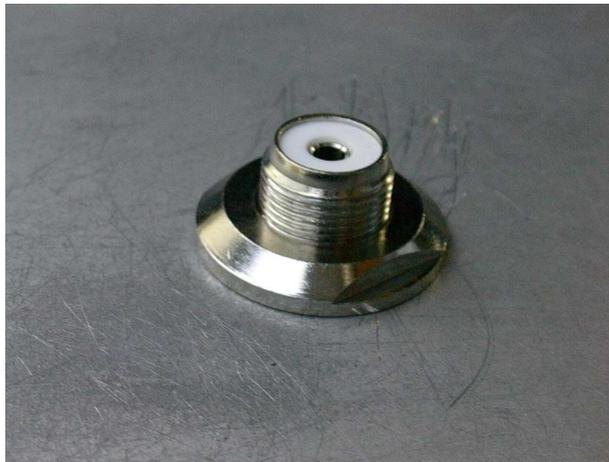
El conector UHF de techo como su nombre lo indica va colocado en el centro del techo del auto de carrera a través de un orificio pasante en el mismo de 16 mm de diámetro y ajustado con tuerca al efecto según podría observarse en la foto anterior que muestra dicho conector del lado exterior del auto.
