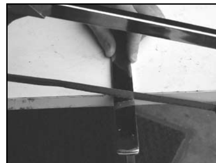
Corte a 15 mm (Minimo) debajo del agujero y alise los bordes.
