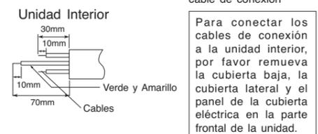
Para conectar los cables de conexión a la unidad interior, por favor remueva la cubierta baja, la cubierta lateral y el panel de la cubierta eléctrica en la parte frontal de la unidad.
