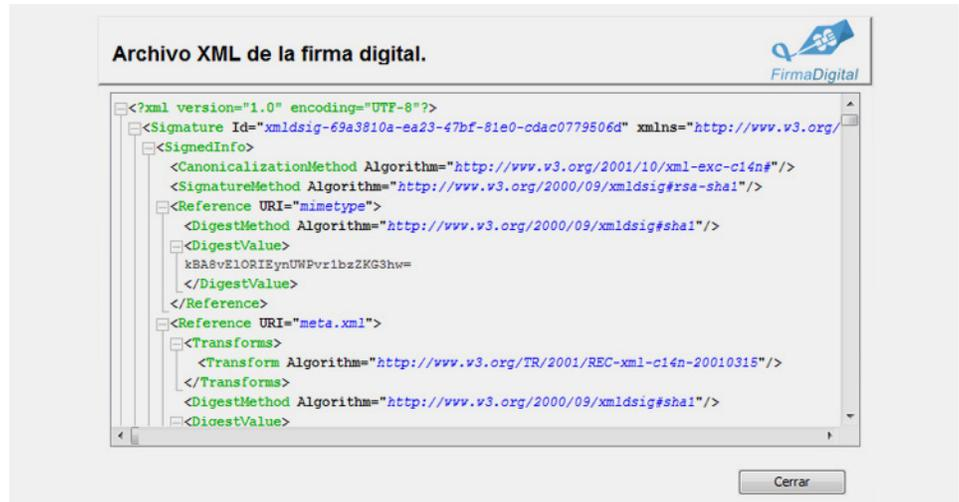
Ilustración 19 Ventana ver XML, para ver la estructura interna de la firma digital.
