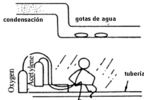
**5.5 Se deben aislar tanto la línea de líquido como la de gas para evitar condensación de agua**
