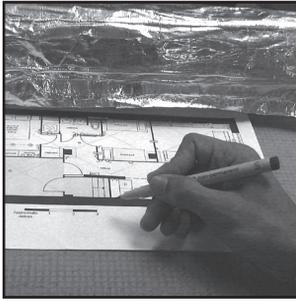
Antes de proceder a la instalación, diseñe un esquema de la instalación en el que se muestre el lugar de colocación de las redes, el sensor de temperatura del suelo y la caja o cajas de derivación.
