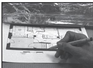
Antes de proceder à instalação, faça um esquema da mesma no qual seja apresentado o local de colocação das redes, do sensor de temperatura do chão, e da caixa de derivação eléctrica.
