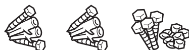
Tornillos de fijación de la placa base y ángulo a la pared
