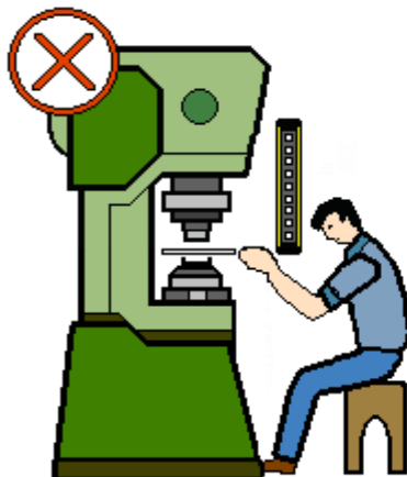
Penetración por Debajo de la barrera
