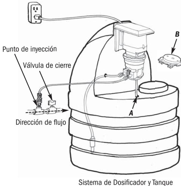
**IMPORTANTE! El sistema está equipado con 4 tornillos instalados a cada lado del soporte de montaje para prevenir daños durante el transporte. Por favor remuévalos al realizar la instalación, para facilitar el deslice del dosificador del soporte cuando sea necesario.**
