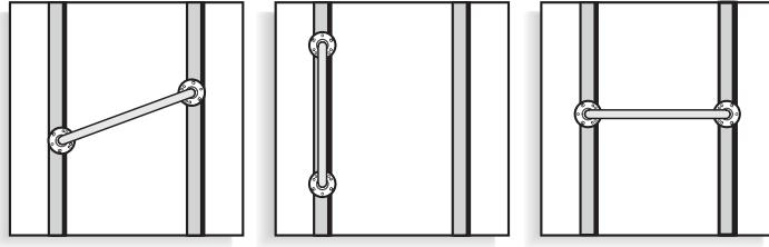
2. Marquez le mur avec précision pour tous les trous de montages utilisés en vous assurant qu'au moins DEUX (2) vis dans chaque bride de fixation entrent en contact avec un montant de bois dans le mur.
