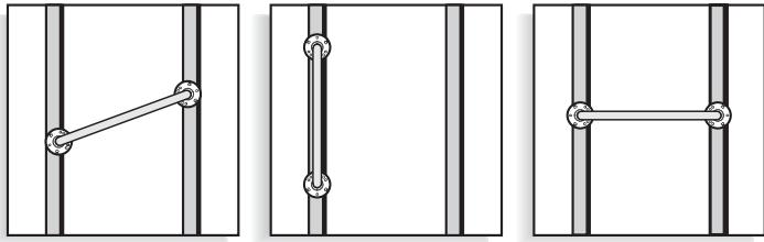
2. Marque con precisión la pared para todos los orificios de montaje que se usen y asegúrese de que, al menos, DOS (2) tornillos en cada brida de montaje se contacten con firmeza con una viga de madera dentro de la pared.
