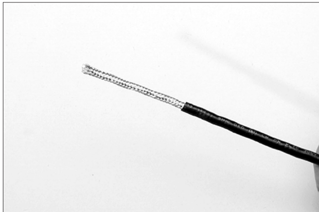
Figura 3.15: desmontaje de la chaqueta plástica exterior
