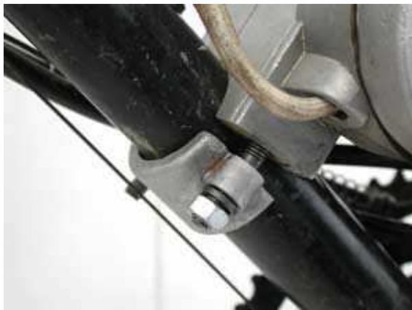
**Paso 4:** Instalar momentáneamente el silenciador o pipa. Esto determinara la posición del motor respecto al eje longitudinal de la bicicleta (que este centrado). Empujar o rotar el motor hasta que el tubo del silenciador tope con el del marco, separar 1 o 2 mm, verificar que los pedales giren libremente
