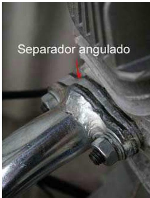
Es aconsejable sellar las uniones del tubo de escape con silicona RTV (alta temperatura) antes de instalarlo para evitar pequeñas fugas.
