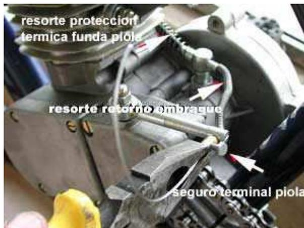
La posición correcta del brazo actuador del embrague es donde se siente un tope, en ese punto colocar el seguro terminal piola y apretar firmemente.
