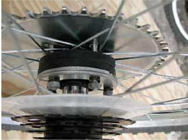
**Durante el paso 4 y 5 se deberá tener cuidado de verificar el correcto centrado del plato o piñón auxiliar en la prolongación de la masa de la rueda donde va montado.**
