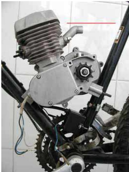
**Paso 2:** Colocar primero la abrazadera trasera. Esta abrazadera es la principal en el anclaje y sirve para posicionar todo el conjunto y determinar su correcta ubicación (posición respecto de la pipa de escape, tapa cadena, placa o soporte auxiliar delantero). Una vez verificado una correcta posición del motor instalaremos la abrazadera delantera o placa auxiliar según sea el caso.
