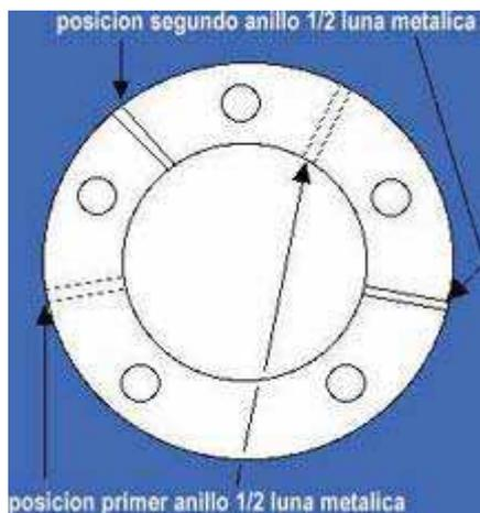
**Paso 5 :** Colocar las tuercas y sus arandelas (golillas) de presión. Apretar en forma circular pareja y solo algunas vueltas cada ves hasta llegar a unas 30 lbs de torque. (cuando las arandelas (golillas) se aplanan).
