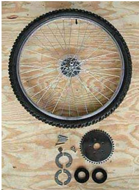
Los elementos necesarios para la siguiente etapa son : A) Plato o piñón auxiliar. B) 5 pernos con sus respectivas tuercas y arandelas (golillas) de presión. C) 2 discos de goma con 5 perforaciones. D) 2 pares de medias lunas metálicas con 2 y 3 perforaciones respectivamente. B,C y D están dentro de un pequeño bolso de tela color lila.
