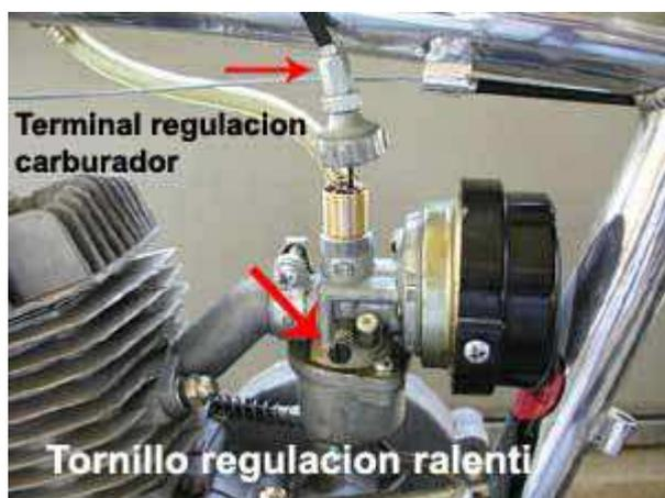
**Regulación acelerador:** Con la ayuda de los terminales de regulación del cable (puño y carburador) se deberá procurar una tensión tal que no exista punto muerto en el recorrido del acelerador, es decir que apenas se gire el puño, se logre tensión en el cable, accionando el carburador.
