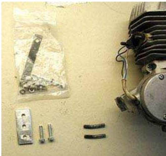
**Paso 2:** instalar placa auxiliar en motor.
