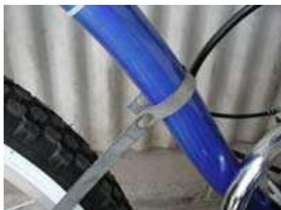
**Paso 2 :** Luego de doblar la curva del tubo de la bicicleta debe doblarse la del escape, quedando una forma de 8 en donde coinciden las perforaciones.
