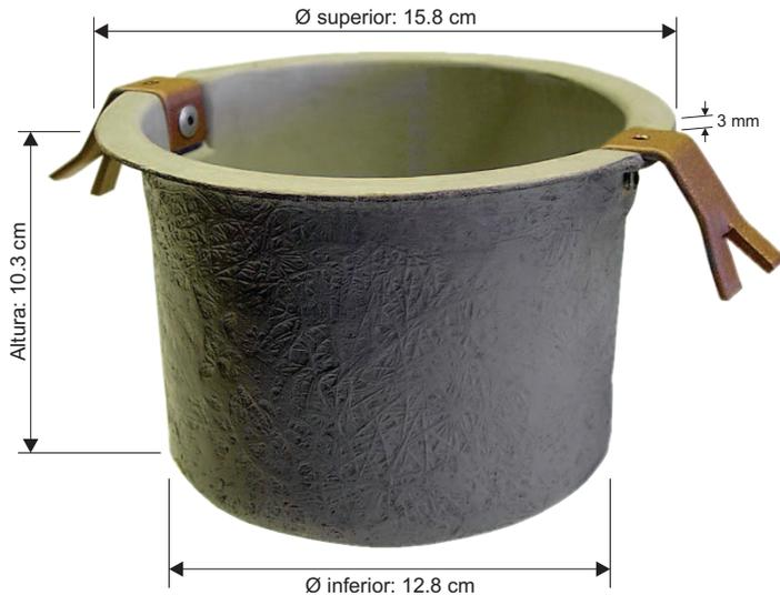
Nota: La altura de 10.3 cm es la altura total de la Carcaza incluyendo la pestaña de 3mm. La carcaza debe ser ahogada totalmente en concreto, la pestaña deberá quedar al ras de la superficie.
