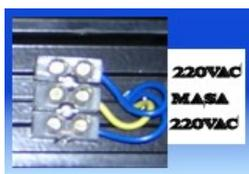
Si el modelo es de 15cm o mas, se conecta 220VAC en la bornera de 3 contactos entre extremos, tierra o masas en el medio.
