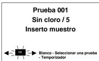
Coloque el **TUBO DE MUESTRA** en la cámara de pruebas y, a continuación, pulse **[OK]**.
