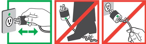
**⚡** PRECAUCIÓN: La desconexión de la alimentación para este equipo se realiza desenchufando el cable de alimentación de CA. Por esta razón, el enchufe deberá tener fácil acceso y deberá instalarse cerca del equipo.
