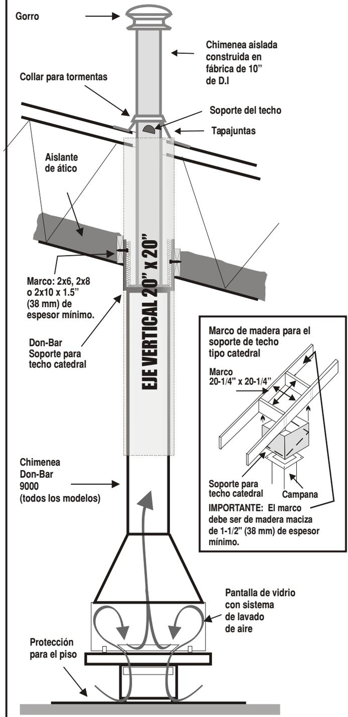
**NOTA:** Todos los soportes de techo (estándar y de la catedral) son universales para todos los modelos de la Serie 9000. Esto significa que el modelo de chimenea puede ser elegido después de la instalación de la chimenea.
