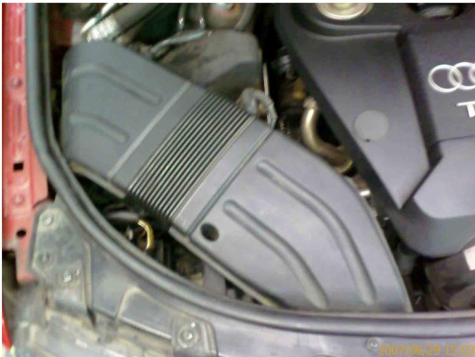
El otro faro (lado acompañante) esta debajo del tubo de entrada de aire, por lo tanto debemos desmontarlo.
