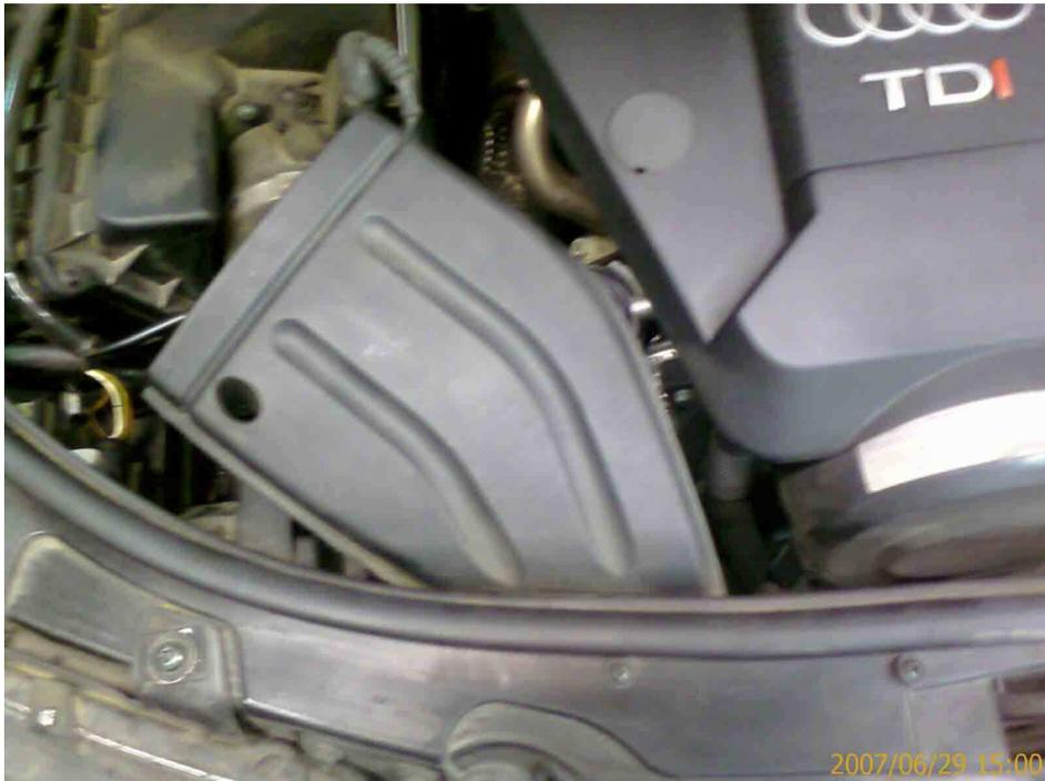
Ahora es necesario sacar los 2 tornillos de estrella que sujetan el tubo y este queda completamente suelto.
