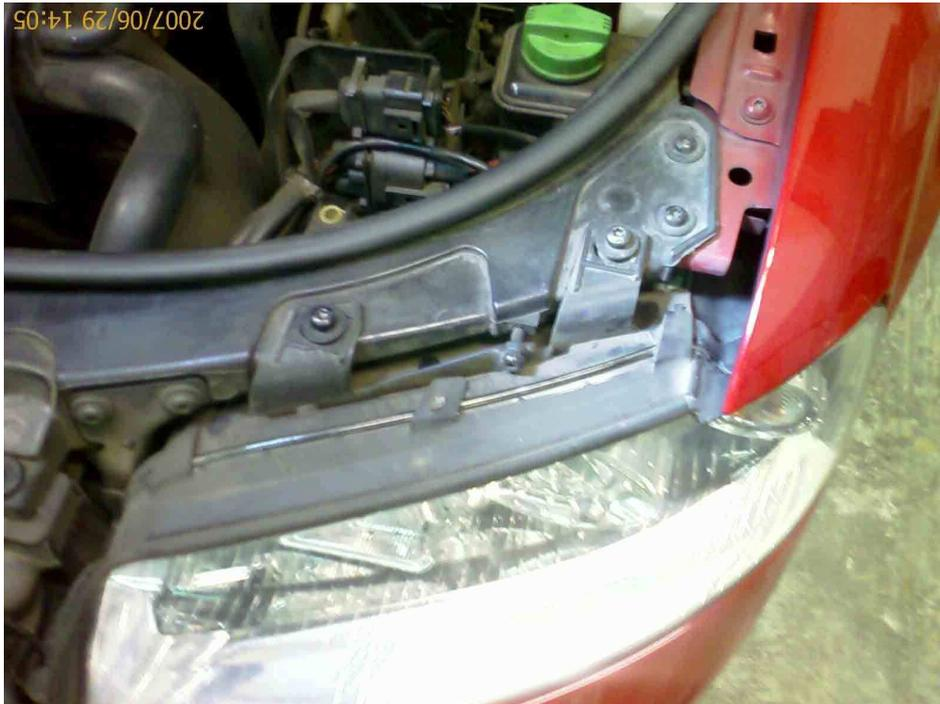
Empezaremos desmontando ambos faros. El faro (lado conductor) lleva 4 tornillos Torx que lo sujetan. 2 en la parte superior y 2 en la parte trasera del faro, estos últimos no debemos sacarlos, tan solo aflojarlos para que el faro pueda salir hacia delante.
