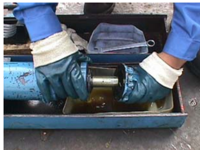
Figura No. 3 Retirando Tapas Protectoras
