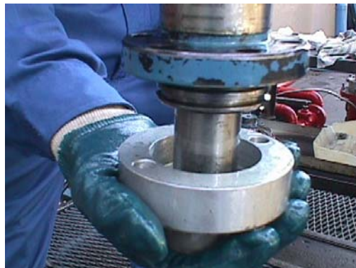
Figura No. 47 Inspeccionar las ranuras de los O Ring
