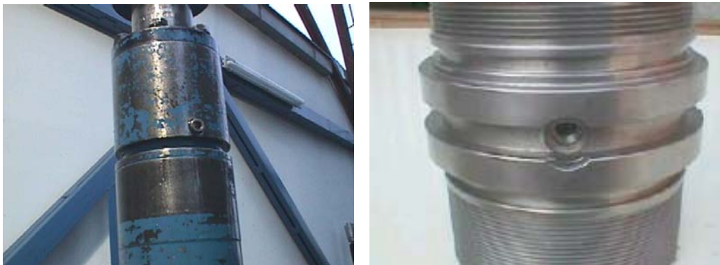
Figura No. 59 Instalando Tapón Sin Junta
