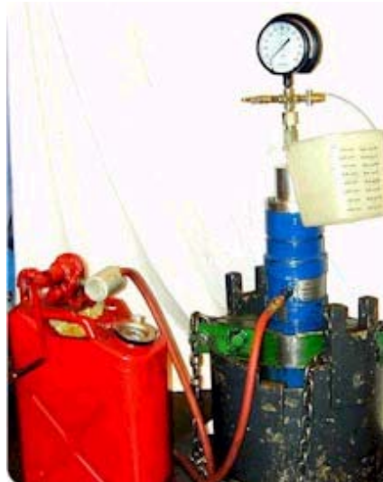
Figura No. 38 Bomba de Llenado de Aceite
