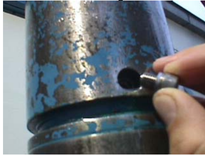
Figura No. 60 Instalando Tapón Con Junta de Plomo
