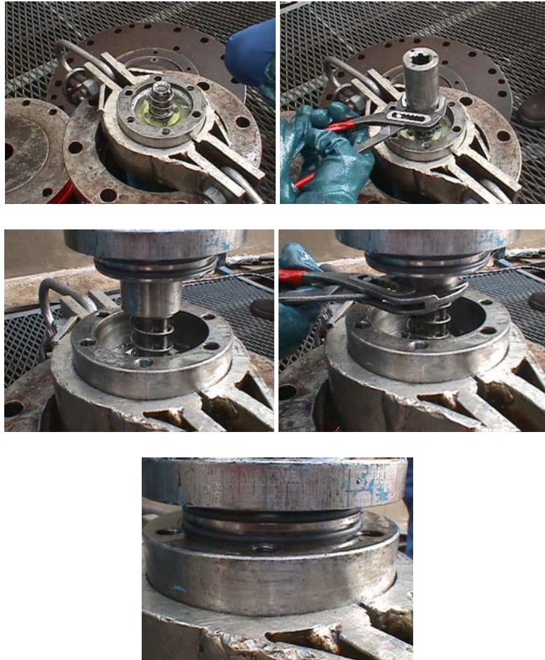
Figura No. 44 Pasos de Encaje el acoplamiento sobre el eje y la unión sellada con O Ring.
