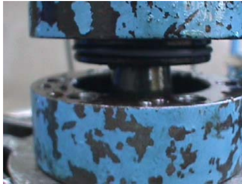
Figura No. 77 Acoplando Bomba con O Ring
