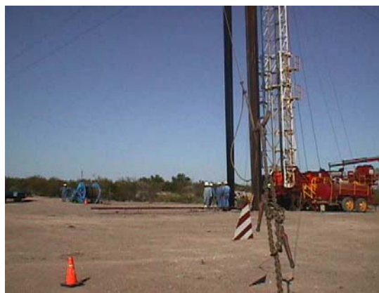
Figura No. 27 Ubicación Del Spooler respecto del equipo de Pulling
