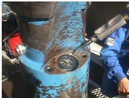
Figura No. 80 Limpieza a fondo al block aislante del motor con aceite CL5
