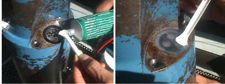
Figura No. 81 Colocar la grasa siliconada P/N 41419 en todos los espacios del block aislante
