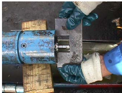
Figura No. 25 Control de extensión del eje utilizando calibre
