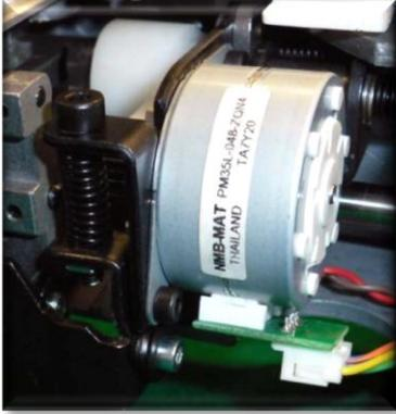
En el PMS del arrastre de las máquinas rotativas electrónicas no puede regularse porque lo ajusta un motor.
