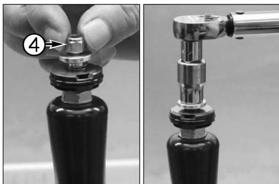
– Atornille una nueva tuerca de seguridad ④ en el soporte de los niveles de compresión.
