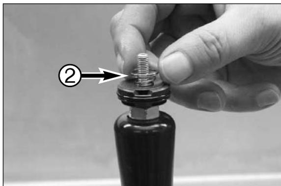
– Coloque el muelle de la válvula de control ②.
