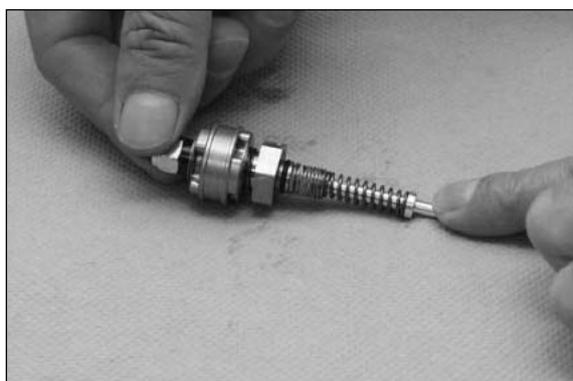
**Ensamblar el adaptador de ajuste de las amortiguaciones en la extensión**
