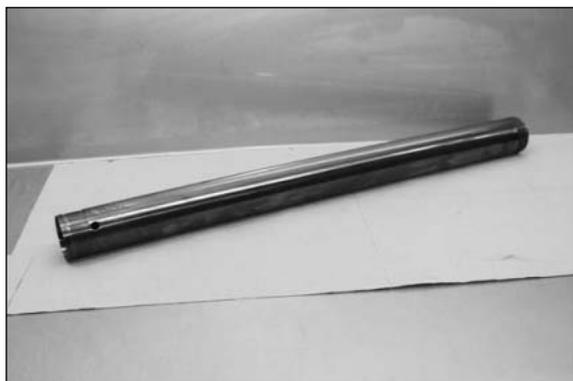
– Examine posibles rasguños, desgaste o fisuras de la superficie de recorrido del tubo interior.
