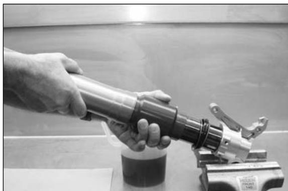
– Presione la junta del aceite en el tubo exterior.
