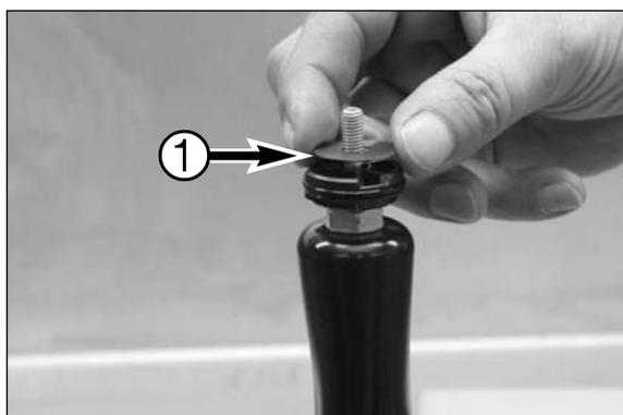
– Coloque el setting de la válvula de control ①.
