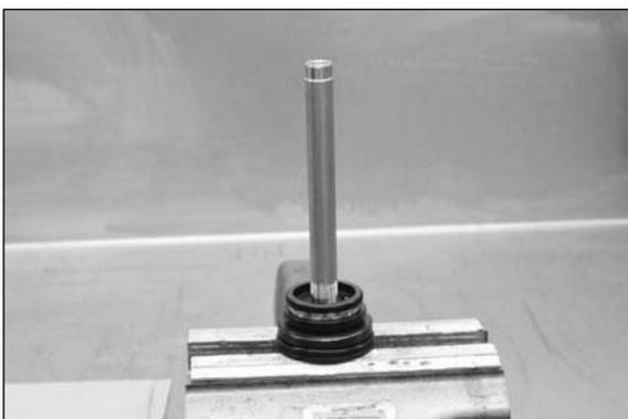
– Posicione el cierre del tornillo en el tornillo de banco como se muestra en la fotografía.
