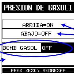
Para cambiar el estado de funcionamiento, presione <ARRIBA> ó <ABAJO>.
