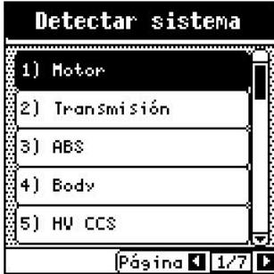
Al ir presionando las teclas <ARRIBA> ó <ABAJO> la lista se desplazara sistema por sistema.
