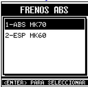
Ya que se ha identificado al tipo de sistema de control adecuado, seleccione por medio de las teclas <ARRIBA> ó <ABAJO> la opción adecuada y presione <ENTER>.
