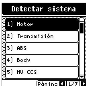
Para localizar el sistema que se requiere diagnosticar, puede usted presionar las teclas <ABAJO> ó <ARRIBA> para desplazar la lista que aparece en la pantalla.
