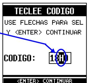
**PASO 5.** Repita el procedimiento de los PASOS 3 y 2 para cambiar el cuarto dígito.
