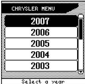
Esta es la primera pantalla que se muestra. Para seleccionar el año adecuado, mueva el cursor con las teclas <ARRIBA> ó <ABAJO> hasta localizar el año requerido.
