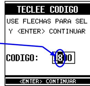
**PASO 4.** Repita el procedimiento de los PASOS 3 y 2 para cambiar el tercer dígito. Aquí la diferencia es que el tercer dígito a ingresar es letra. Por lo tanto una vez que el cursor esta colocado en esta posición, se deberá presionar la tecla <ABAJO> hasta localizar la letra adecuada.
