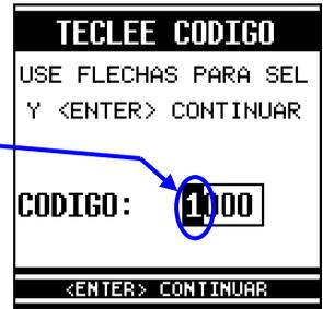
**PASO 3.** Presione la tecla <ENTER> para colocar al cursor en el siguiente dígito. Repita el procedimiento del PASO 2 para cambiar el dígito adecuado
