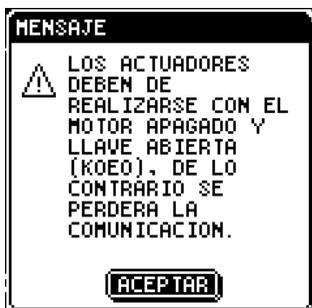
Una vez que se han cumplido las condiciones requeridas, presione nuevamente <ENTER> y entonces aparecerá la lista de actuadores según el sistema que se está diagnosticando.
