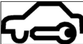
Lámpara testigo del Sistema de Inmovilizador en el tablero
