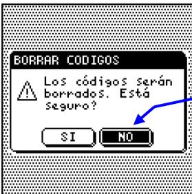
Aquí aparece esta pantalla, para asegurar de que realmente requiere borrar los códigos. De ser así, presione la tecla <IZQUIERDA> para cambiar de posición al cursor.
