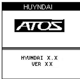
Al cabo de unos segundos, se desplegara una pantalla que indica en que modelo de vehículo se utiliza este programa. Solo presione <ENTER> para que se despliegue el menú de sistemas.
