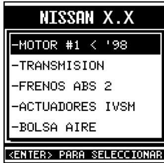
Entonces, coloque el cursor sobre el sistema que desea diagnosticar, por medio de las teclas <ABAJO> ó <ARRIBA>.
