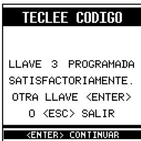
**PASO 14.** Una vez terminado el proceso, presione <ESC> cierre el contacto de ignición, retire la llave del interruptor y desconecte al CJ-4 del vehículo, entonces espere unos dos minutos antes de insertar nuevamente cualquiera de las llaves programadas.
