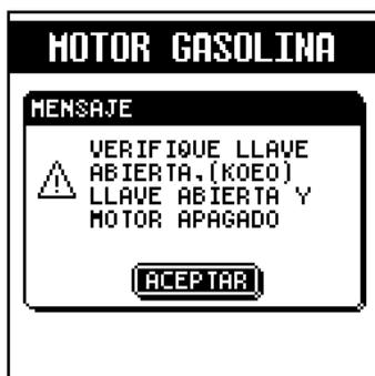
Esta condición es establecida por el fabricante del vehículo, por lo tanto, cierre la ignición del vehículo e inmediatamente vuelva a conectarla, sin encender al motor. Una vez realizada esta operación presione <ENTER>, y se iniciara el proceso de borrado de averías.
