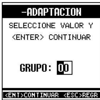
En este caso, el canal para Adaptar es el 01, para cambiar el numero de canal, presione la tecla <DERECHA> para cambiar de posición al cursor.
