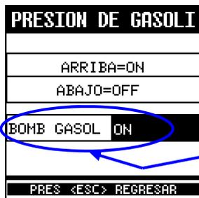
Se presiono la tecla <ARRIBA> y aquí el estado de funcionamiento ya cambio.
