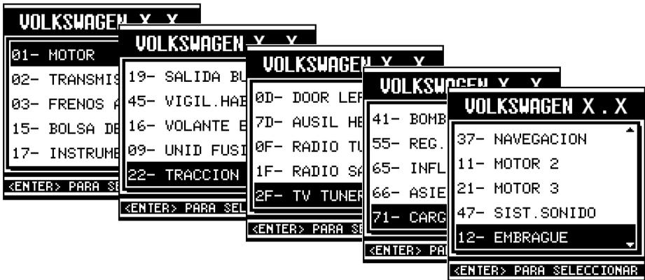
Por medio de las teclas <ABAJO> ó <ARRIBA> coloque el cursor en el sistema que desea diagnosticar. Entonces la lista de sistemas se irá desplegando, según las veces que se ha presionado las teclas <ABAJO> ó <ARRIBA>. Una vez que ha colocado el cursor en el Sistema adecuado, presione <ENTER> para que aparezca el Menú de Diagnóstico
