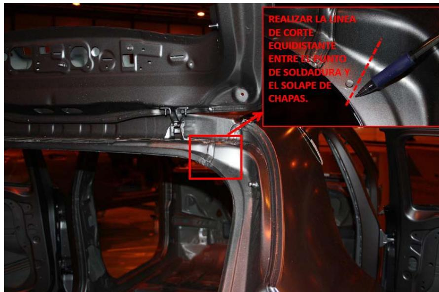
**Zona Estribo:** La línea de corte coincide con la marca "Y", según se muestra en la foto siguiente
