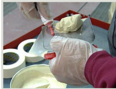
Mezcla de la masilla con su catalizador
