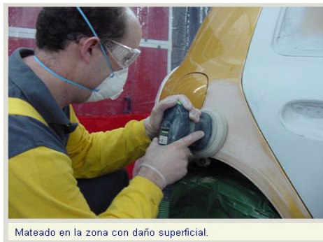
Mateado en la zona con daño superficial.
