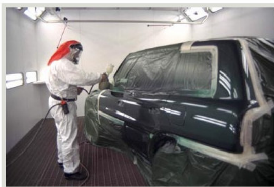
Aplicación de las pinturas de acabado
