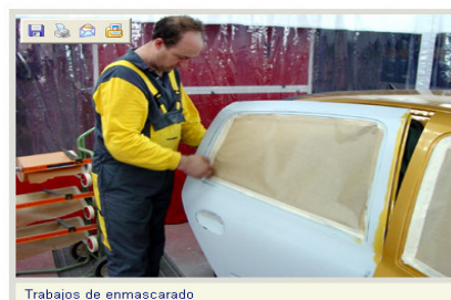
Trabajos de enmascarado
