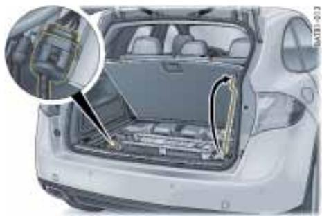
1. Abrir la tapa el maletero. La conexión de 12 voltios que ha de ser desconectada se encuentra a la izquierda de la batería de alto voltaje.
