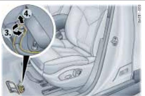
3. Desconectar el cable de masa de la batería de 12 voltios a la altura del conector roscado (-3-).
