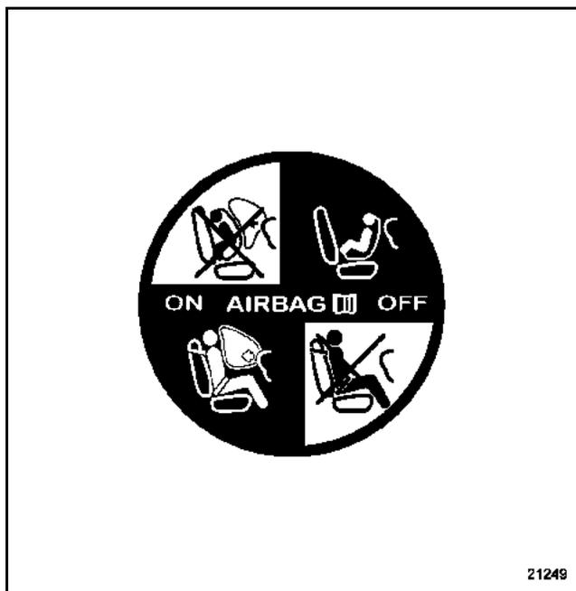
En caso de cambiar el tablero de bordo equipado de un airbag del pasajero, es imperativo poner en su lugar (en el costado del tablero de bordo), la etiqueta de preconización anterior. Esta etiqueta está disponible en la colección Almacén de Piezas de Recambio (referencia 77 01 205 442).
