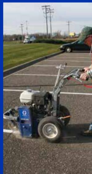
El **GrindLazer 270** es el esscarificador perfecto para la eliminación de líneas de estacionamiento. Su Sistema de montaje de rueda EasyGlide hace que sea tan fácil de utilizar como un LineLazer y su diseño robusto e innovador implican que usted puede contar con que rendirá durante toda una vida de uso.
