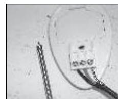
La résistance doit être mesurée entre les deux conducteurs, le bleu et le noir. Comparer la résistance mesurée à celle mentionnée sur l'étiquette du produit (sur le fil d'alimentation). Noter la résistance sur la fiche de garantie. Les résistances entre la terre (nu) et les conducteurs bleu et noir devraient aussi être mesurées, et devraient être infinies.
