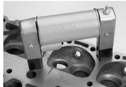
Ponga el imán en la surficie de la cabeza. El polvo mostrará claramente grietas entre las astas del imán, también debajo de la surficie.
