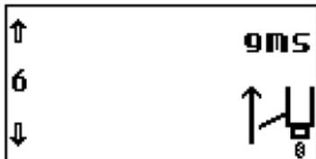
La pantalla de configuración n° 6 sirve para dos funciones: alternar entre medida de cantidad de disparo en centímetros cúbicos o gramos, y alternar entre modos de pistola “Toque” y “Mantener”.
