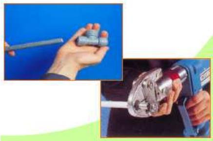
Los sistemas de unión por press-fitting consisten en introducir un accesorio metálico dentro del tubo y terminar la unión, por presión, bien de un elemento metálico externo al tubo, bien por presión con herramientas especiales sobre la parte del tubo que abraza el accesorio.
