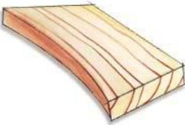
Fig-35 retorcimiento del tablero
