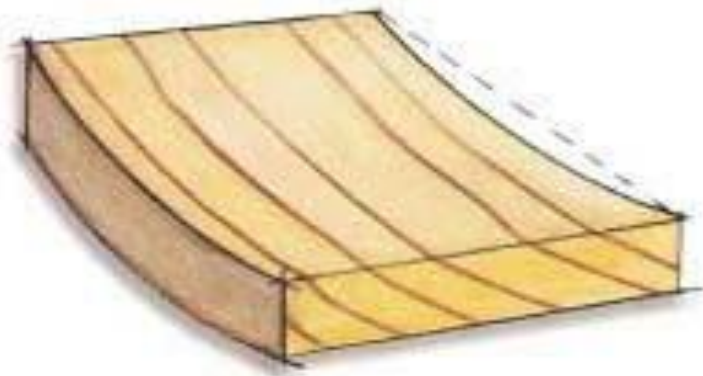
Fig-32 Alabeo comba de la cara del tablero en sentido longitudinal.
