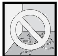
**Fig.35** - En las losas a base de cemento la presencia de grietas por contracción higrométrica se debe a uno o varios de los siguientes factores: exceso de agua en el amasijo, agregado de granulometría demasiado fina, cantidad excesiva de cemento. Antes de la colocación es necesario sellar las grietas.
