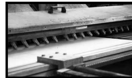
**Fig.27** - Para realizar un corte a 45° se pueden utilizar discos diamantados con una inclinación de 45°. De esta manera es posible realizar una arista con dos placas de KERLITE de cualquier tipo. Luego la arista se deberá achaflanar. Es posible obtener numerosos tipos de acabado de borde utilizando diferentes muelas. La velocidad operativa se debe probar previamente.
