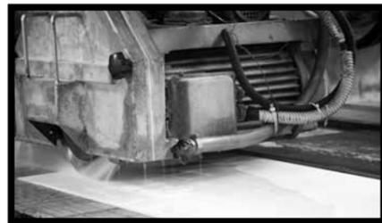
**Fig.21** - Todos los tipos de KERLITE se pueden cortar utilizando discos diamantados. Los discos deben ser para gres porcelánico y estar en buenas condiciones. Se recomienda proceder con altas velocidades de rotación (>2000 rpm) y velocidades de avance de 0,5 a 1 m/min. Según el tipo de disco y la longitud del corte, puede ser necesario enfriar el disco con agua.
