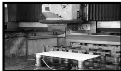
**Fig.22** - Todos los tipos de KERLITE se pueden cortar utilizando máquinas de control numérico. La fresa para estas máquinas requiere una velocidad de rotación de 12000 a 18000 rpm, con velocidad de avance de 0,5 a 1 m/min.
