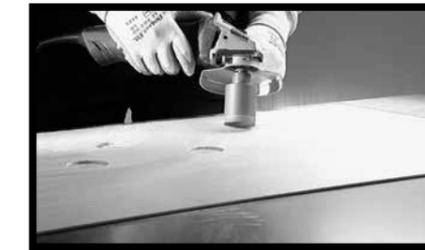
**Fig.16/17** - Como alternativa es posible utilizar fresas de disco (o perforadoras) montadas en esmeriladoras, taladros eléctricos o atornilladores a batería.
