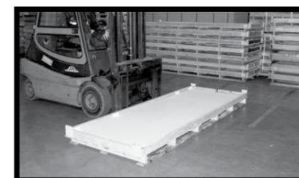
**Fig.7** - Para tomar el palet por el lado largo, poner las horquillas distanciadas al menos 1 m entre sí, perpendiculares al lado largo del palet, y en el centro de éste. Las horquillas deben sujetar el palet en toda su profundidad.
