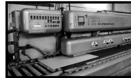
**Fig.26** - Para la formación y el pulido del borde es necesario, en primer lugar, utilizar muelas diamantadas y abrasivas con el fin de obtener un borde de la medida y la forma requeridas; luego, se utilizará una muela pulidora. Es posible obtener numerosos acabados de borde utilizando diferentes muelas. La velocidad operativa se debe probar previamente.
