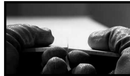
**Fig.11** - Una vez realizada la incisión, es suficiente una simple flexión para separar los dos trozos de placa.
