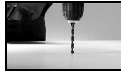
**Fig.15** - Para la perforación manual se pueden utilizar puntas de tungsteno de hasta 10 mm de diámetro montadas en taladros eléctricos o atornilladores a batería.
