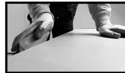
**Fig.18** - Los acabados de los bordes se pueden realizar a mano empleando esponjas diamantadas o papel de lija. Con una pasada ligera sobre el costado de la placa se puede obtener un efecto rompehilo, o con varias pasadas un efecto bisel.
