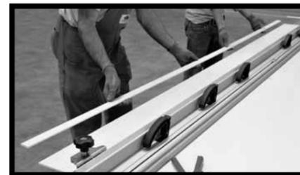
**Fig.13** - Una herramienta práctica para realizar los cortes es la regla cortaplacas (tipo KeraCut de **Sigma** o Free-cut de **Raimondi**). En el caso de KERLITE PLUS, una vez realizado el corte de la parte cerámica y quebrada la placa, con un cúter común se corta la fibra de vidrio (**Fig.12**).
