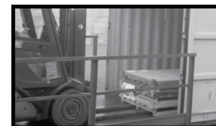
**Fig.8** - Para tomar el palet por el lado corto (ej. al descargar containers) utilizar indefectiblemente horquillas de al menos 2,5 m para asegurar un agarre perfecto y la integridad del material levantado.
