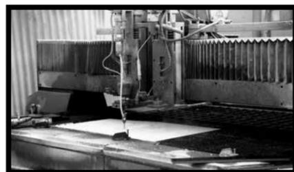
**Fig.23** - Todos los tipos de KERLITE se pueden cortar utilizando máquinas de chorro de agua. Recomendamos utilizar una velocidad de 2 a 3 m/min.
