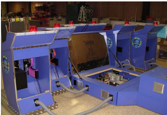
Figura 18: pasar por el orificio del módulo de conexión alimentación los cables de altavoces y conectar a los altavoces correspondientes.
