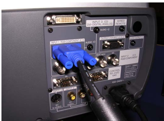
Figura 15: pasar el cable de VGA por el módulo de proyector, luego por el módulo conexión alimentación hacia el módulo espejo.
