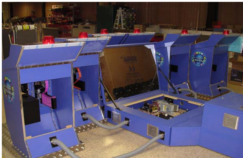
Figura 11: colocar en posición módulo conexión alimentación y conectar cables altavoces y alimentación red.
