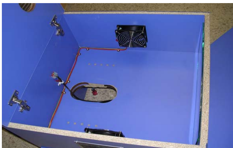
Figura 12: colocar sobre módulo conexión alimentación el módulo de proyección y luego colocar dentro de éste el proyector
