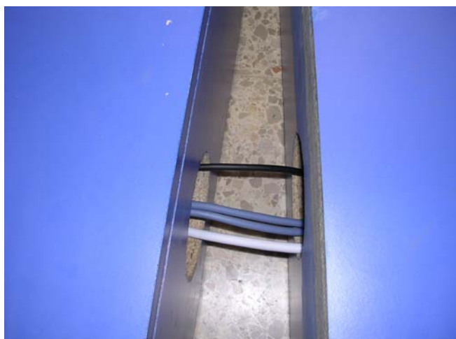
Figura 15: pasar el cable de VGA por el módulo de proyector, luego por el módulo conexión alimentación hacia el módulo espejo.
