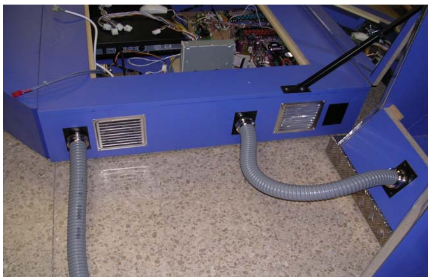
Figura 6: así deben quedar conectados los tubos corrugados
